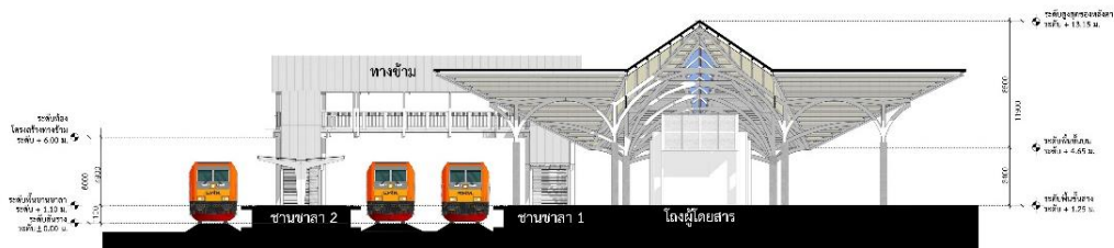
รูปที่ 3.11-15 รูปด้าน และรูปตัด สถานีขนาดเล็ก (แบบที่ 2) และขนาดกลาง
