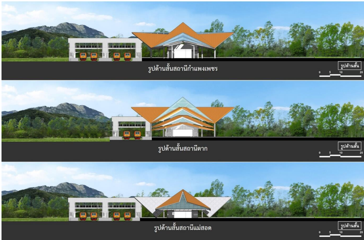
รูปที่ 3.11-23 (ข) รูปด้านและรูปตัด สถานีขนาดใหญ่
