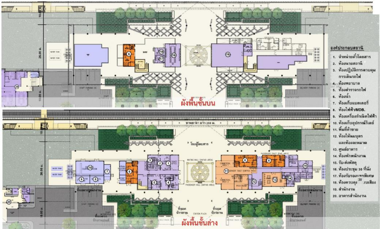
รูปที่ 3.11-22 พื้นที่ใช้สอยอาคารสถานีรวม 1,900 ตารางเมตร สถานีขนาดใหญ่ (สถานีแม่สอด)
