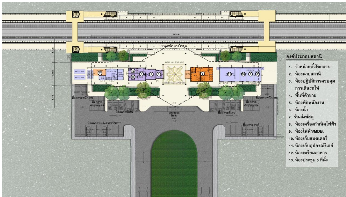
รูปที่ 3.11-10 พื้นที่ใช้สอยอาคารสถานี 500 ตารางเมตร สถานีขนาดเล็ก (แบบที่ 1)
