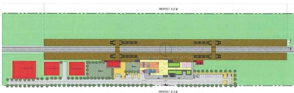
รูปที่ 2.4-4 แสดงวางผังแปลน สถานีขนาดเล็ก (สถานีระดับพื้นดิน)
